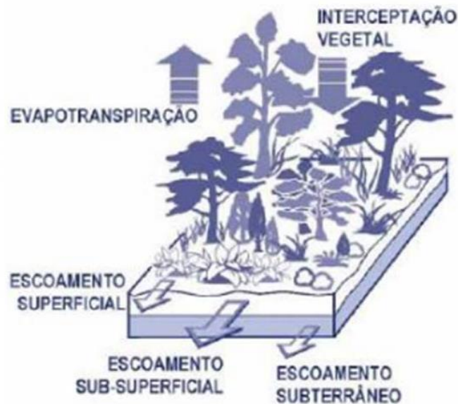
Figura 1 - Caracterização do escoamento subterrâneo, subsuperficial e superficial.
