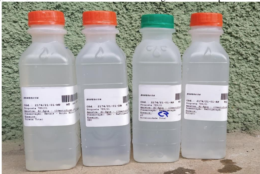
Figura 11: Acondicionamento da amostra de água em frascos para laboratório
