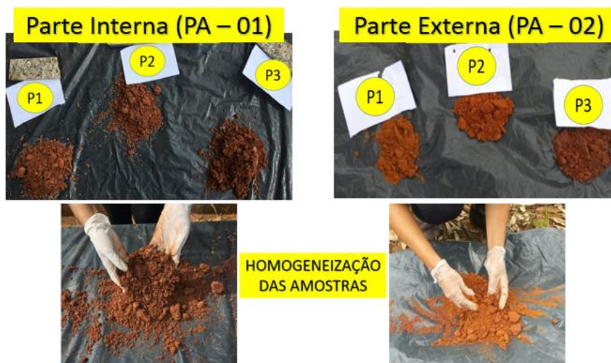
Figura 15: Homogeneização das amostras coletadas na parte interna (PA-1) e externa (PA-2) do cemitério
