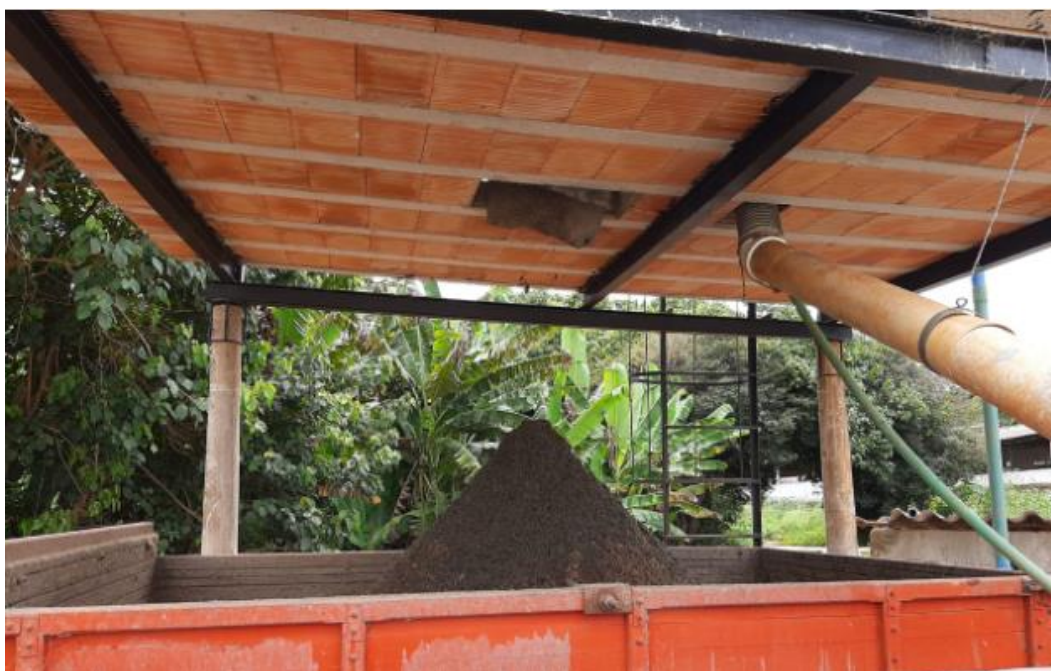
Figura 5.5: Fase sólida do efluente.
