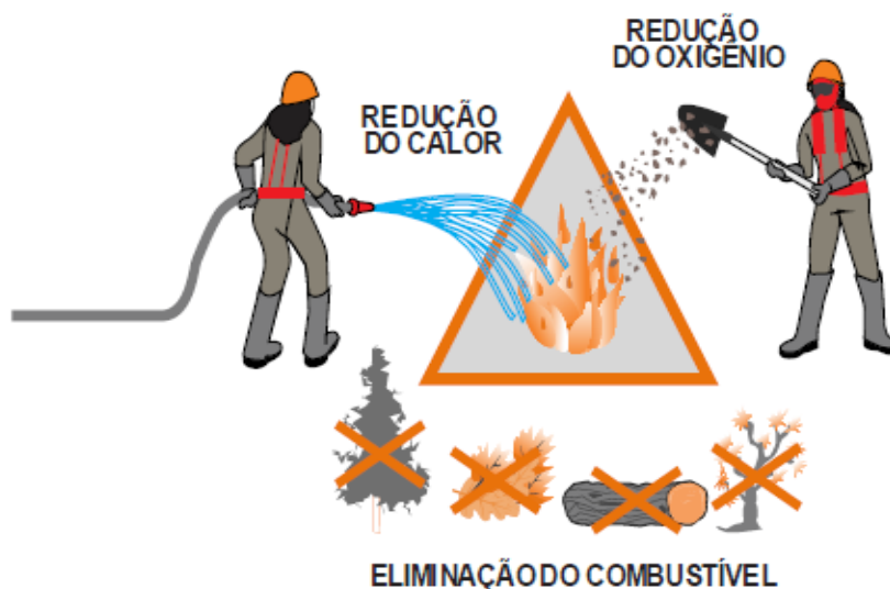
Figura 3.1 - Esquema de quebra do triângulo do fogo
