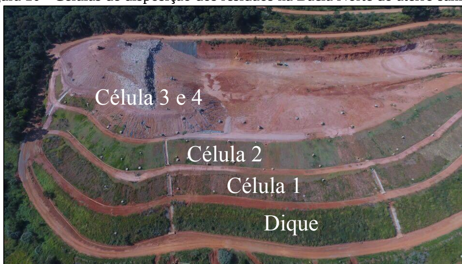
Figura 10 - Células de disposição dos resíduos na Bacia Norte do aterro sanitário
