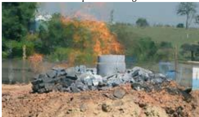
Figura 6 - Flare aberto e queima de biogás em aterro sanitário
