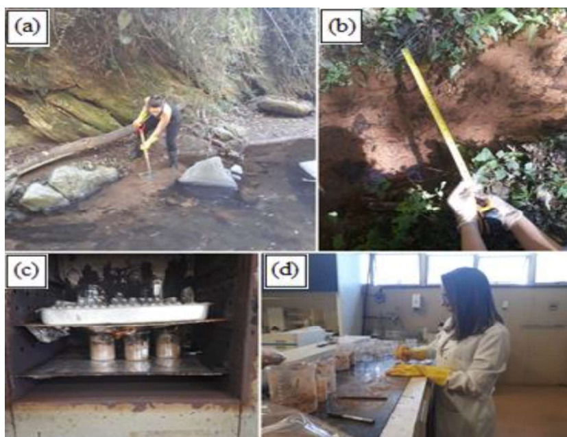
Figura 4 - (a) Coleta de sedimento (b) Medição de largura e profundidade com trena (c) Estufa para secagem (d) Maceração da amostra seca.
