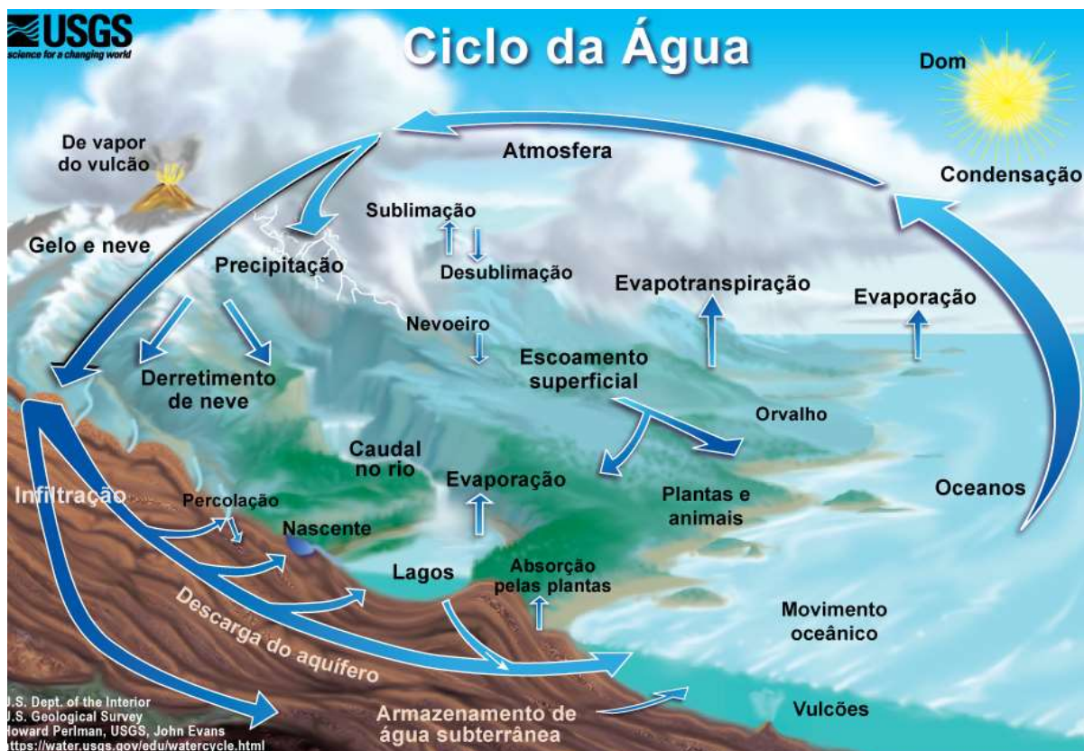
Figura 1 - Representação esquemática dos processos hidrológicos envolvidos no balanço hídrico de uma bacia hidrográfica.
