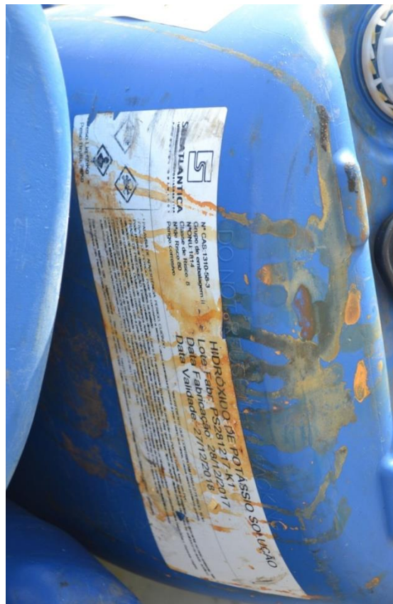
Figura 18 - Embalagem 10, usada para solução de hidróxido de potássio, mostrando a agressão química do produto na própria embalagem.
