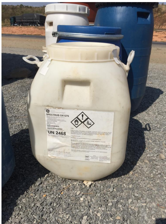
Figura 8 - Fotografia da embalagem 1, com o rótulo acusando o armazenamento do produto direcionado ao controle de agentes microbiológicos de uso industrial, tendo em sua formulação o ácido tricloroisocianúrico componente, dentre outros.
