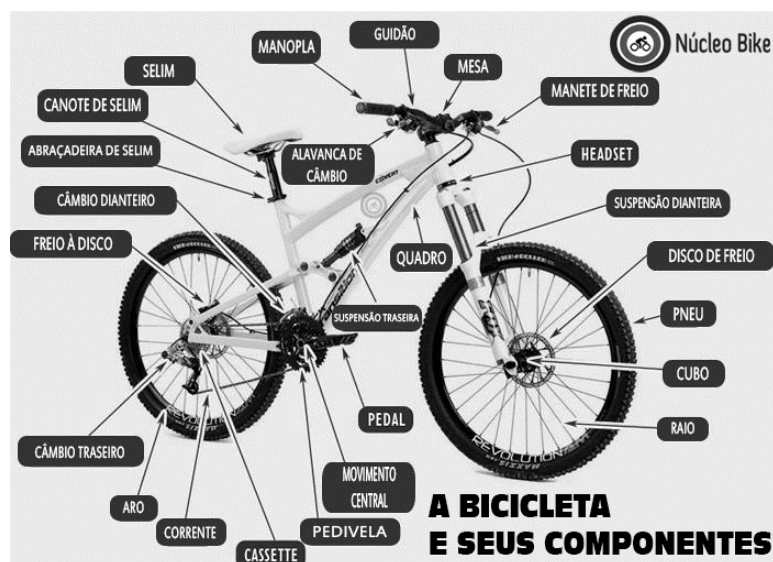
Figura 5 - Itens que compõem uma bicicleta.
