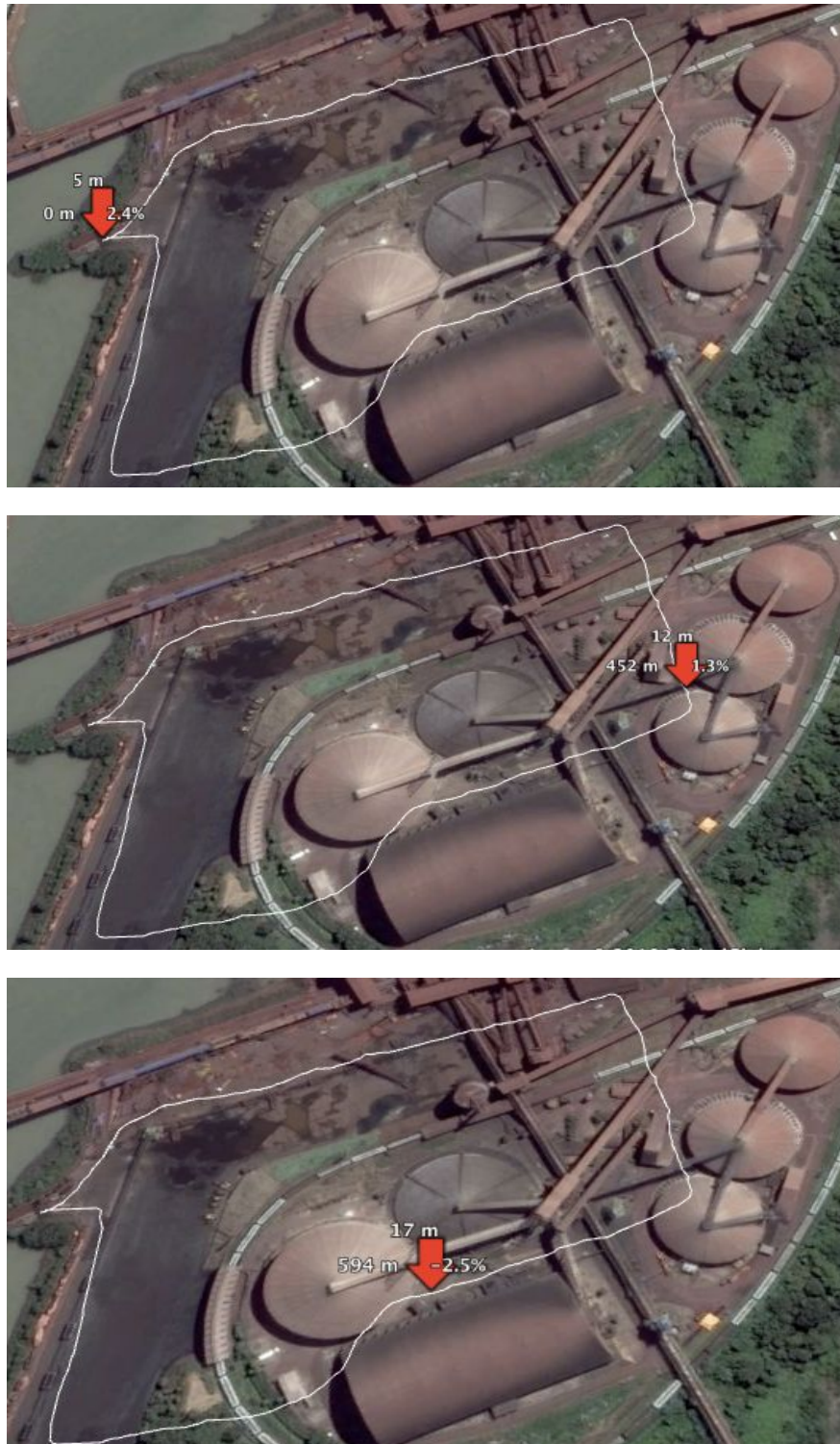
Figura 16: Perfil de elevação da bacia de contribuição da ETEI. a) ponto mais baixo do terreno próximo a ETEI. b) elevação do ponto próximo aos silos. c) ponto mais alto, também localizado próximo aos silos.
