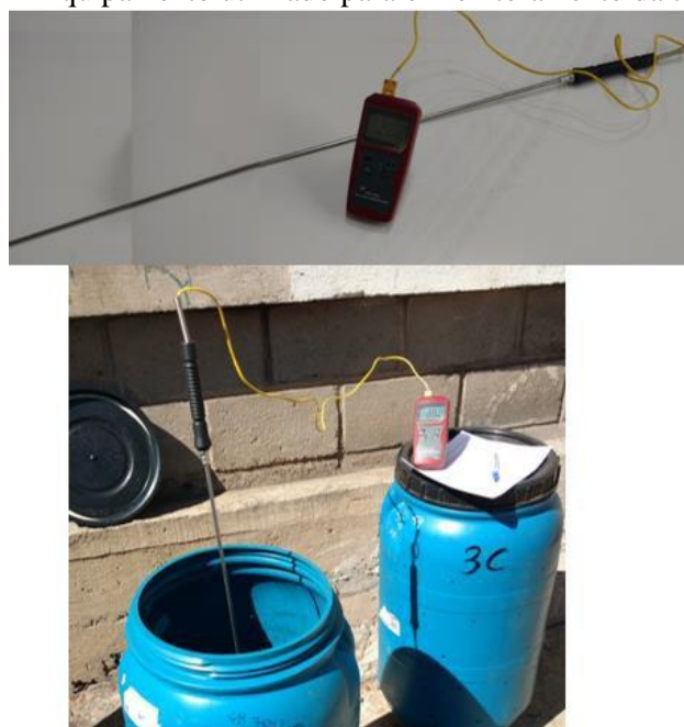
Figura 12 – Equipamento utilizado para o monitoramento da temperatura.
