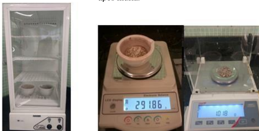
Figura 20 – Resfriamento dos cadinhos no dessecador e em seguida a pesagem das amostras após mufla.
