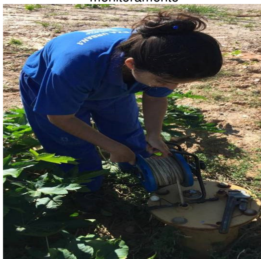
Figura 26- Medição em poço de monitoramento
