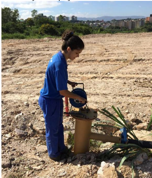
Figura 27 - Medição em poço de monitoramento célula emergencial.
