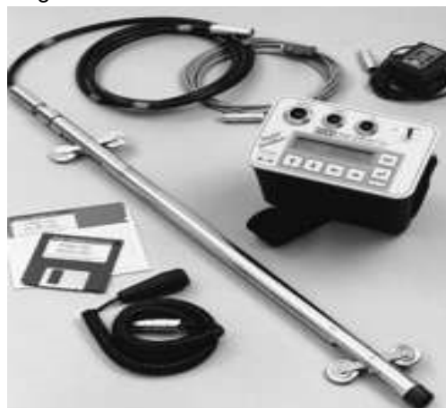
Figura 30 – Sonda e Unidade de Leitura
