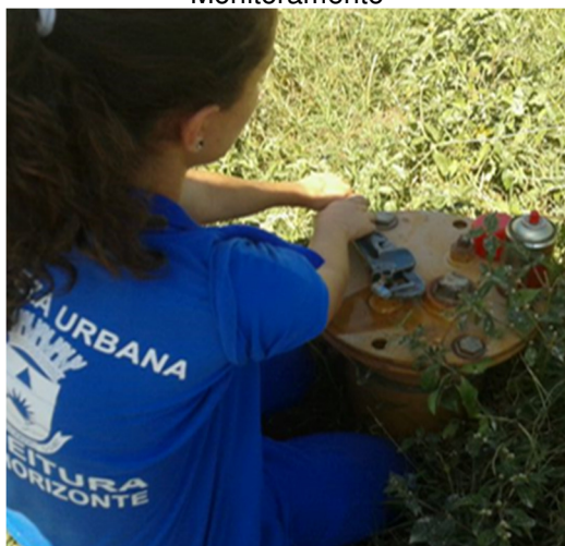
Figura 25 – Abertura de poço de Monitoramento
