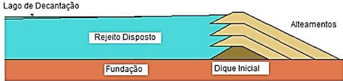
Figura 11: Método construtivo de linha de centro. Fonte: (PASSOS, 2009)
