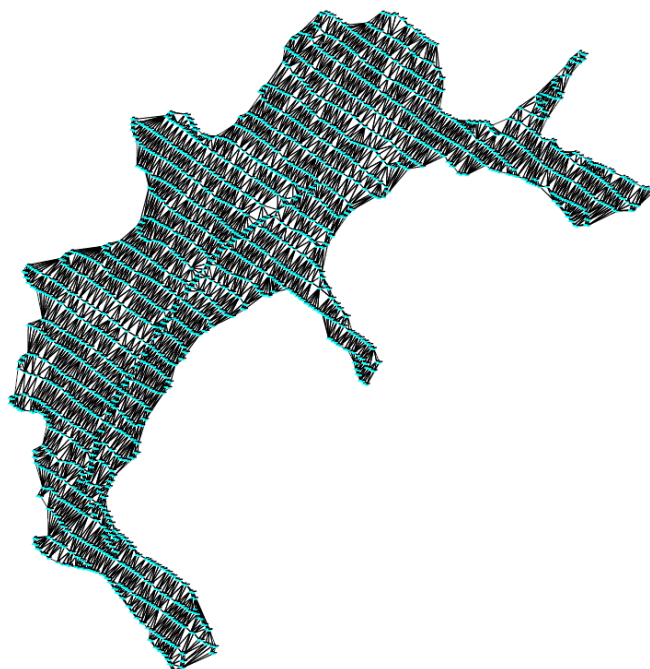
Figura 20 - Triangulação do reservatório A FONTE: Autoria própria
