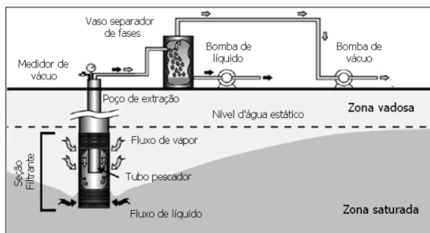
Figura 8. Desenho esquemático de um MPE
