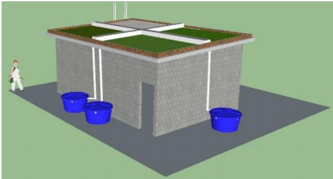
Figura 22 - Reservatórios acoplados ao tubo de descida
