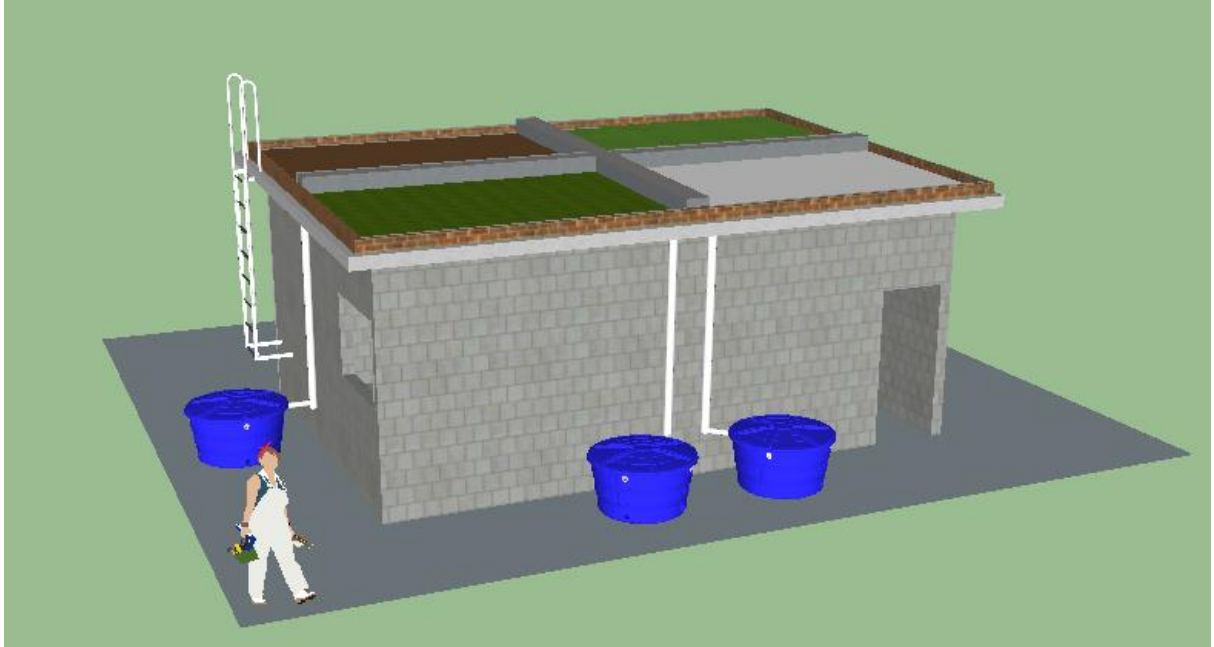
Figura 13 - Perspectiva e componentes da parte experimental instalada na edificação localizada na UFMG
