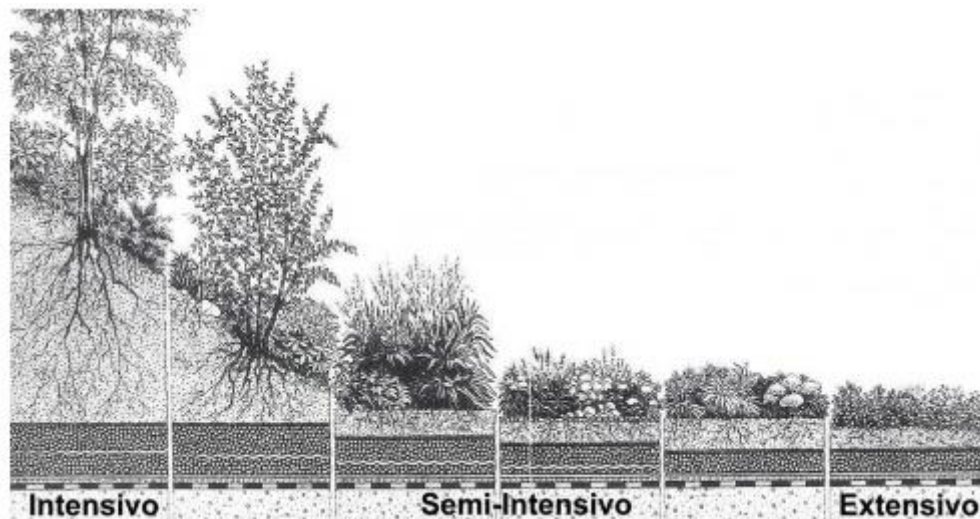
Figura 11 - Classificação dos telhados verdes
