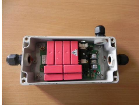
Figura 11 - Caixa de sintonizador de antena
