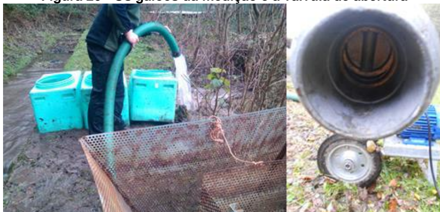
Figura 20 - Os galões da medição e a válvula de abertura
