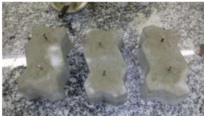
FIGURA 12 - Colocação dos pinos nas amostras
