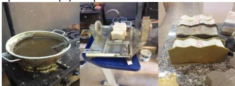
FIGURA 15 - Capeamento da peças de pavimentos intertravados
