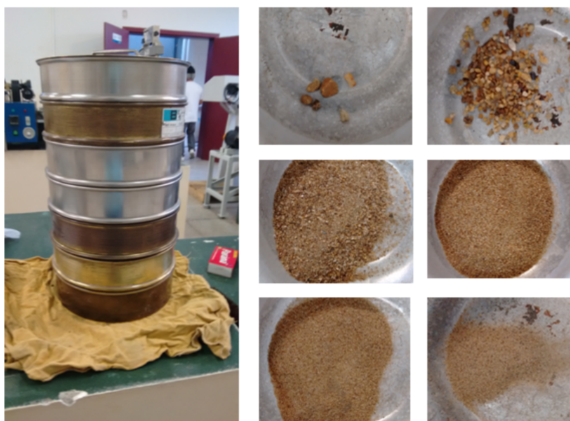
Figura 10 – Granulometria do material agregado miúdo areia convencional passando pela sequência de peneiras descritas anteriormente.
