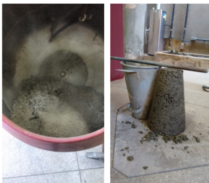
Figura 11 – Betoneira utilizada para fazer a mistura concreto e teste de slump feito.
