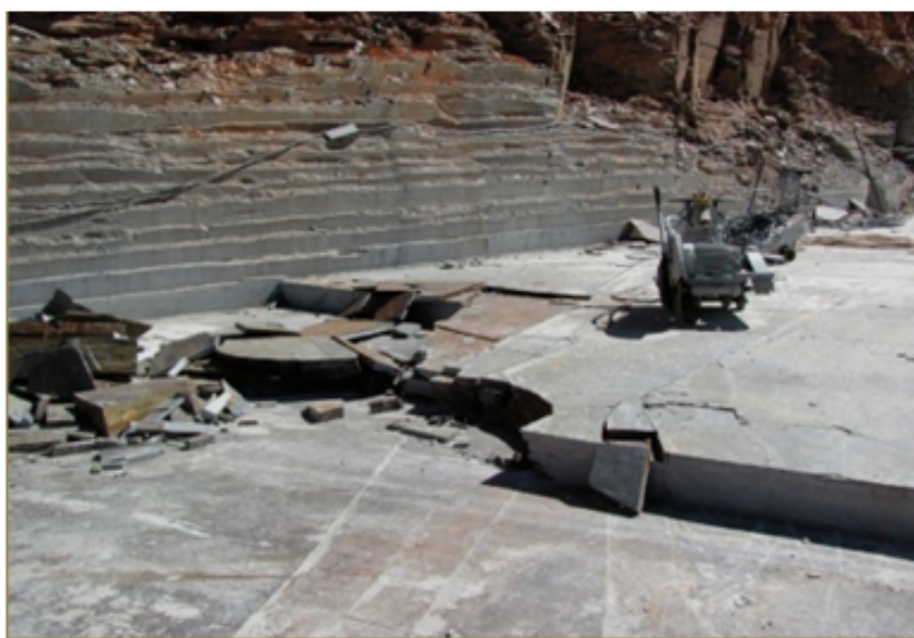
Figura 3 – Frente de lavra de ardósia cinza desenvolvida em bancada ou degrau único sucessivo (FEAM, 2014).
