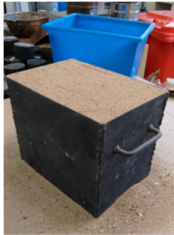
Figura 9 – Determinação da massa unitária da areia utilizando recipiente previamente determinado.
