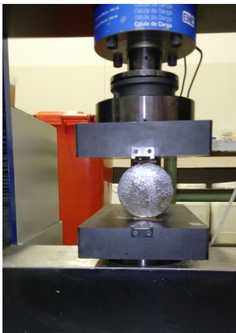
Figura 14 – Ensaio de tração por meio de ensaio de compressão diametral realizado no equipamento PCM100C.
