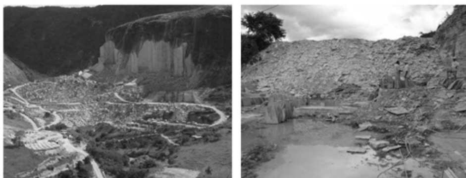
Figura 4 – Rejeitos deixados na pedreira ou dispostos de forma incorreta (FEAM, 2014).
