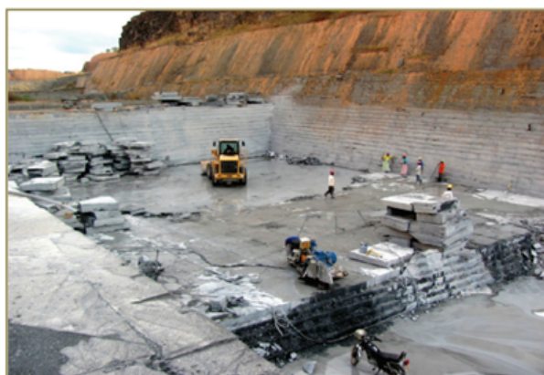
Figura 2 – Frente de larva de ardósia cinza, evidenciando a regularidade e horizontalidade do piso (FEAM, 2014).
