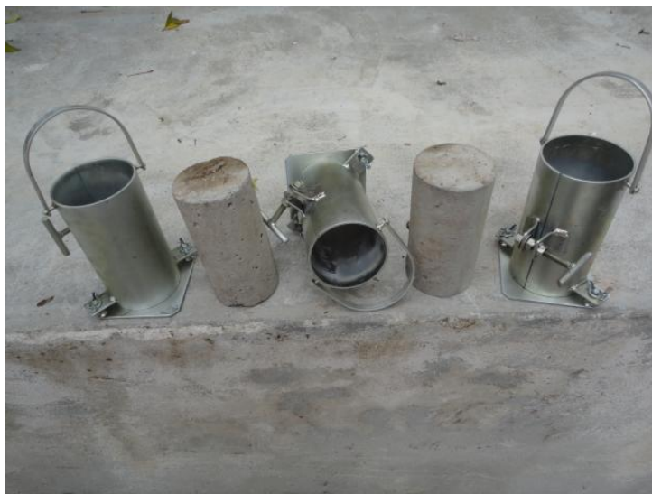
Figura 12 – Forma utilizada para moldagem dos corpos de prova.
