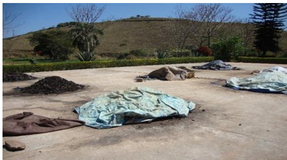
Figura 22 - Pátio de compostagem, com algumas pilhas cobertas, a fim de facilitar o processo de maturação do composto.
