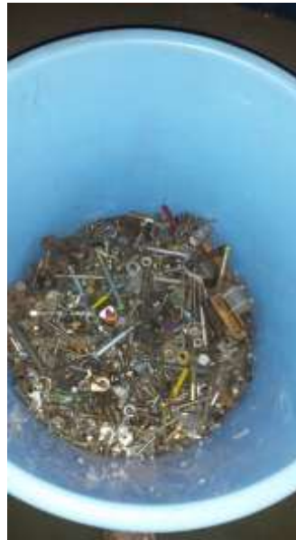
Figura 5 - Sucatas metálicas segregadas e acondicionadas para serem analisadas, separadas e retornadas à produção
