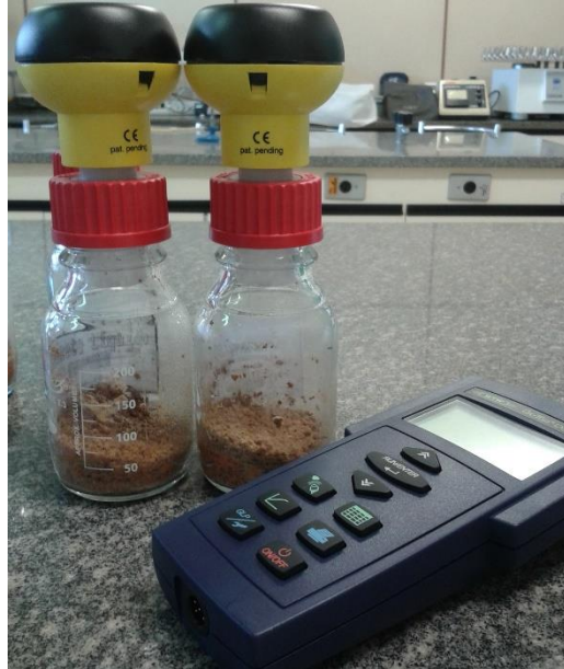
Figura 3- Garrafas e controle remoto usados no monitoramento pelo sistema OxiTop-C ® .
