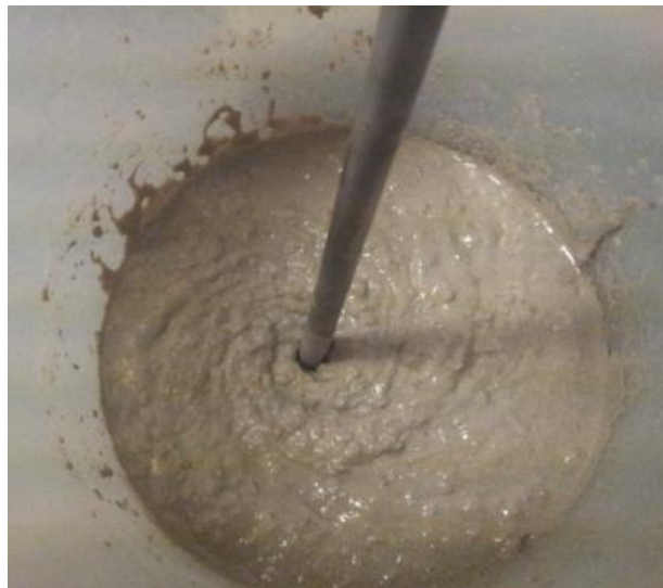
Figura 4 - Mistura homogeneizada da argamassa geopolimérica.
