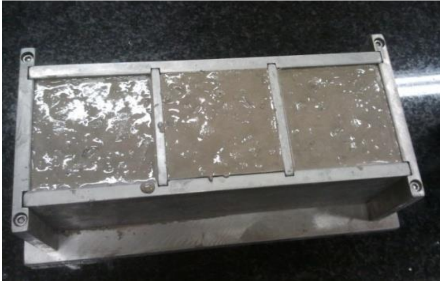
Figura 5 - Moldagem do corpo de prova na fôrma cúbica.
