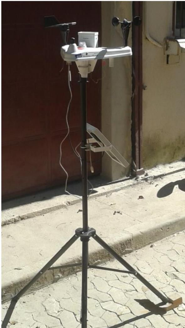
Figura 5. 9 Estação meteorológica Weather Hawk 232 utilizada no estudo
