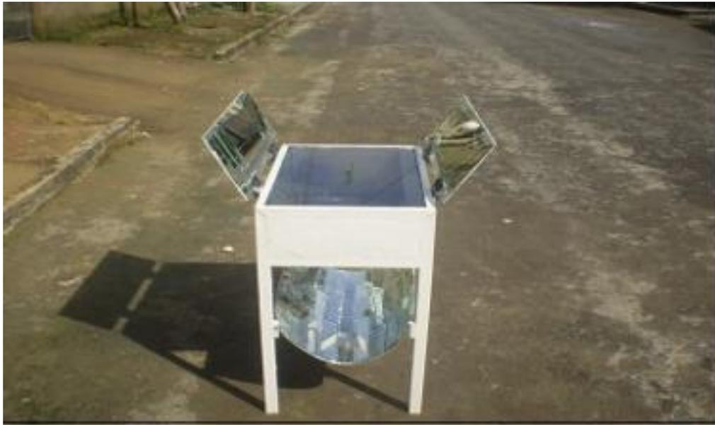
Figura 4.7 Forno solar tipo caixa confeccionado por Filho e Silva (2008).
