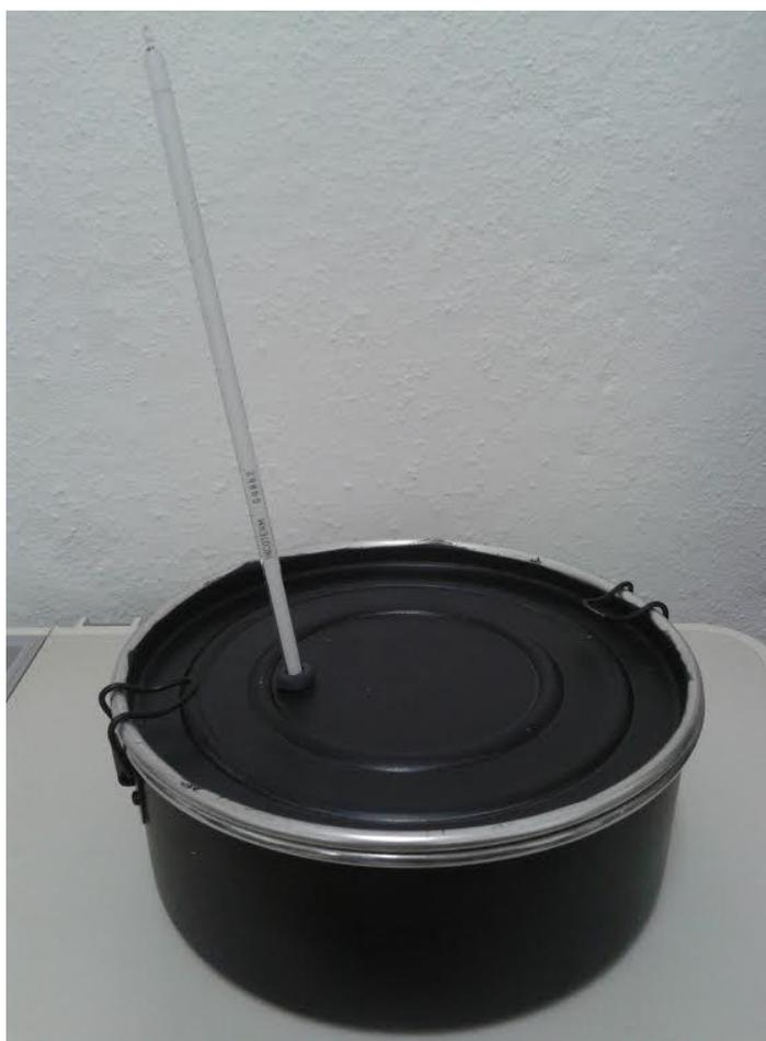
Figura 5. 8 Introdução do termômetro de álcool no interior da marmita.
