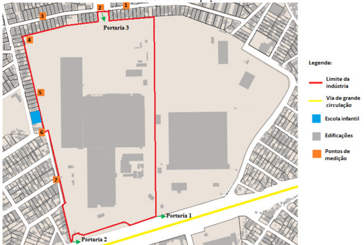
Figura 13 - Localização dos pontos de medição de nível de pressão sonora no entorno da indústria de autopeças
