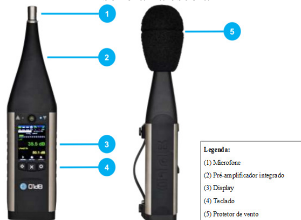
Figura 14 - Medidor de pressão sonora (01 dB FUSION) utilizado nos ensaios de medição sonora na escola
